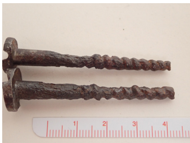
Abb. 12: Handgefertigte Schrauben aus dem 18. Jahrhundert
