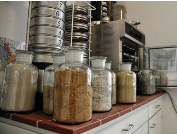
55. Mauerbach, NÖ, Kartause, Erstellen der Sieblinie von Sanden mittels Vibrationsiebzanlage
