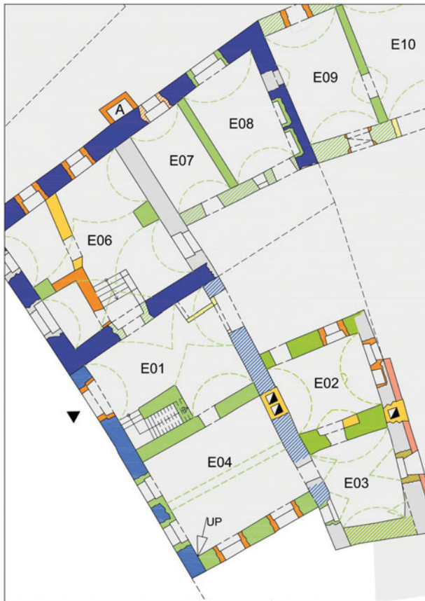
11. Ausschnitt aus dem Baualterplan eines Friesacher Bürgerhauses, Ergebnis der Untersuchung (II.) im Jahr 2015. „UP“ Untersuchungsposition an der südwestlichen Ecke des Raumes E04
