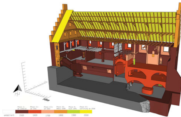
13. Veste Heldburg, Thüringen, Deutschland, so genannter Heidenbau. Schnittperspektive mit Baualterangaben für die einzelnen Konstruktionseinheiten. Bauforschung schafft ein vertieftes Verständnis für die räumlichen, konstruktiven, zeitlichen und kulturgeschichtlichen Zusammenhänge an einem Bauwerk.
