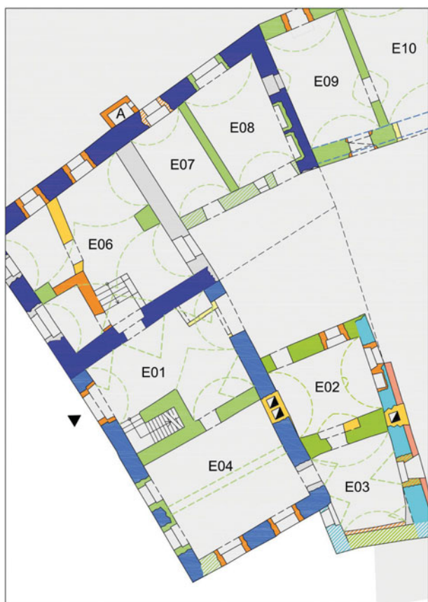
12. Ausschnitt aus dem Baualterplan eines Friesacher Bürgerhauses mit den neuen Erkenntnissen im Zuge der Baubegleitung (III.), Stand 2018
