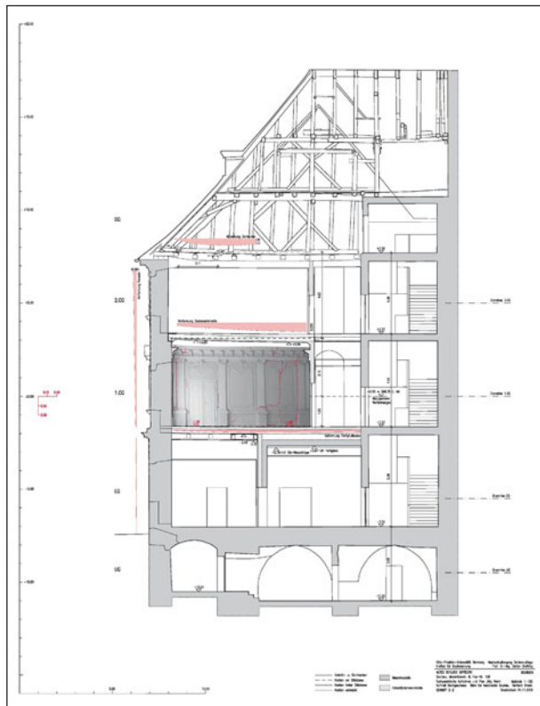
16. Bayreuth, Deutschland, Altes Schloss, SW-Flügel. Querschnitt mit Schadensbild. Im historischen Baubestand ist eine bloß technische Bewertung von Verformungen und Rissen ohne die Rekonstruktion der Schadens- und Sanierungsgeschichte nicht zielführend.
