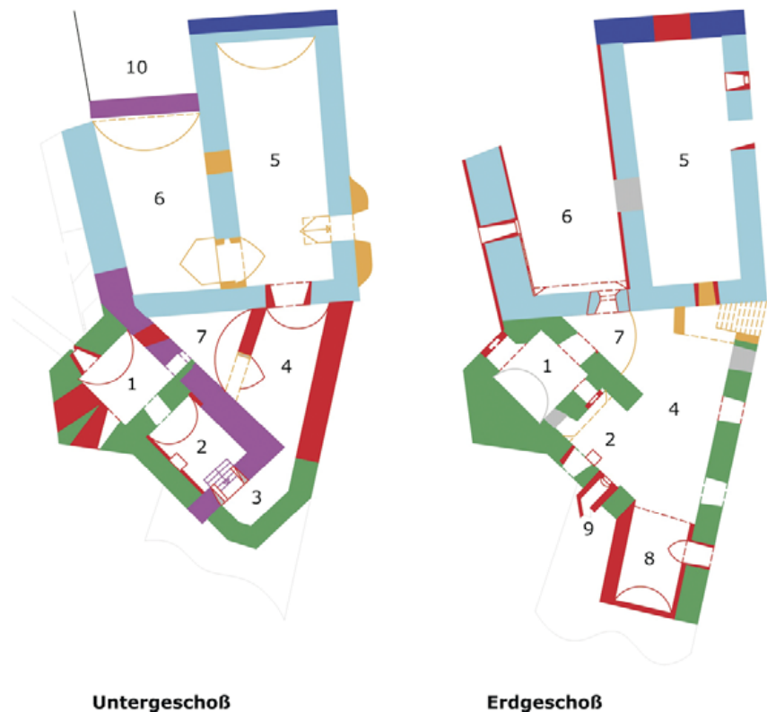
Abb. 2: Burg Güssing. Bauphasenplan des Untergeschoßes und des Erdgeschoßes.
