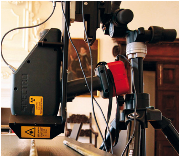
Abb. 14: Handheld Spektrometer Spectro xSort, mit Hilfe des Museumsadapters am Stativ positioniert.
