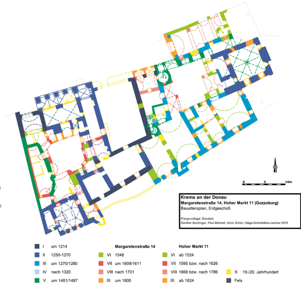
Abb. 2c: Gozzoburg, Bau- altersplan des Erdgeschoßes mit der Einfahrt im Nord- westen, dem anschließenden Saalbau, der gewölbten Küche im Südwesten, den östlich anschließenden Räu- men des Kernbaus und des großen Wohntrakts Gozzos sowie dem Raum unter der Johannes- und Katharinen- kapelle im Osten
