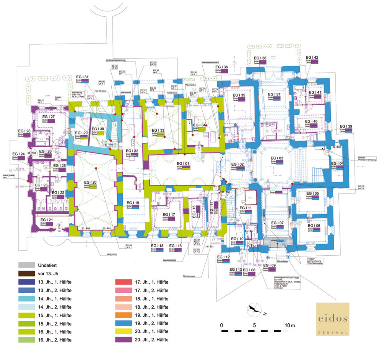
Abb. 9 St. Martin, Schloss Grubhof. Baualterplan des Erdgeschoßes.
