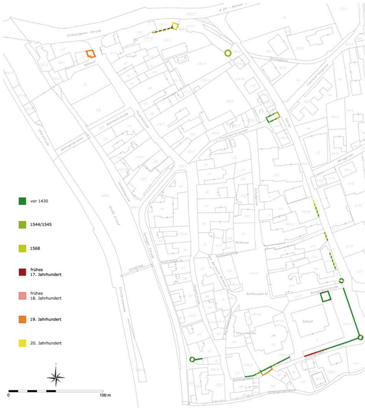
Abb. 31 Scheibbs, Marktbefestigung. Baualterplan der Gesamtanlage.
