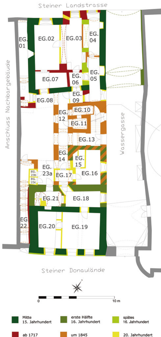
Abb. 33 Stein, Bürgerhaus. Baualterplan des Erdgeschoßes.
