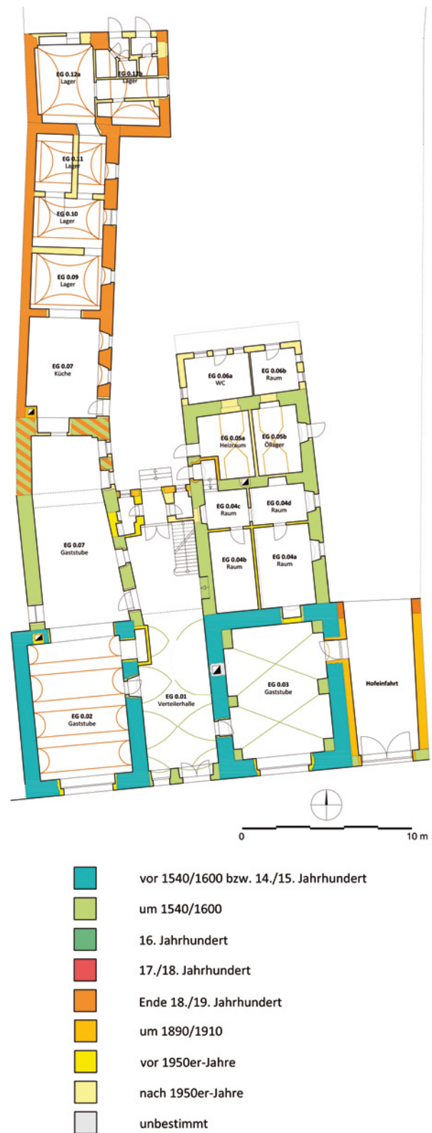
Abb. 8 Horn, Bürgerhaus. Baualterplan des Erdgeschoßes.
